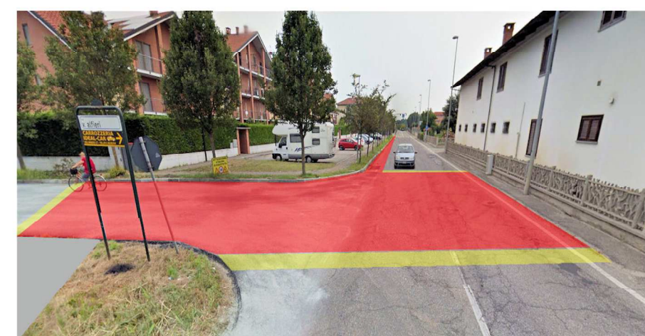
Scenario schematico dell'incrocio rialzato presso via Alfieri e successivo restringimento di carreggiata
