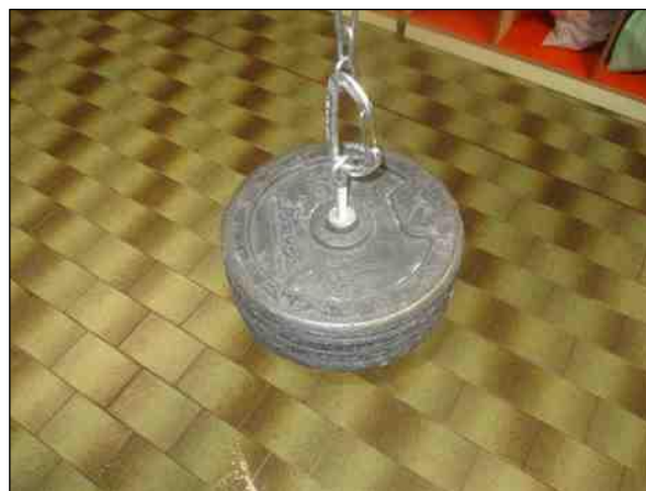
Foto n°3 - Vista dei pesi di prova per controsoffitto in cartongesso.
