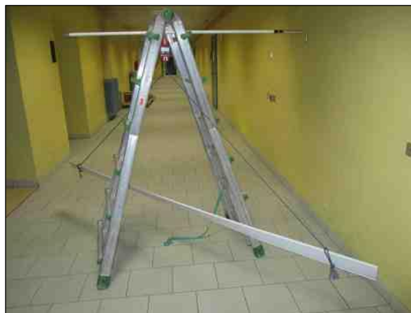
Foto n°4 - Pesatura di un pannello del controsoffitto in doghe.
